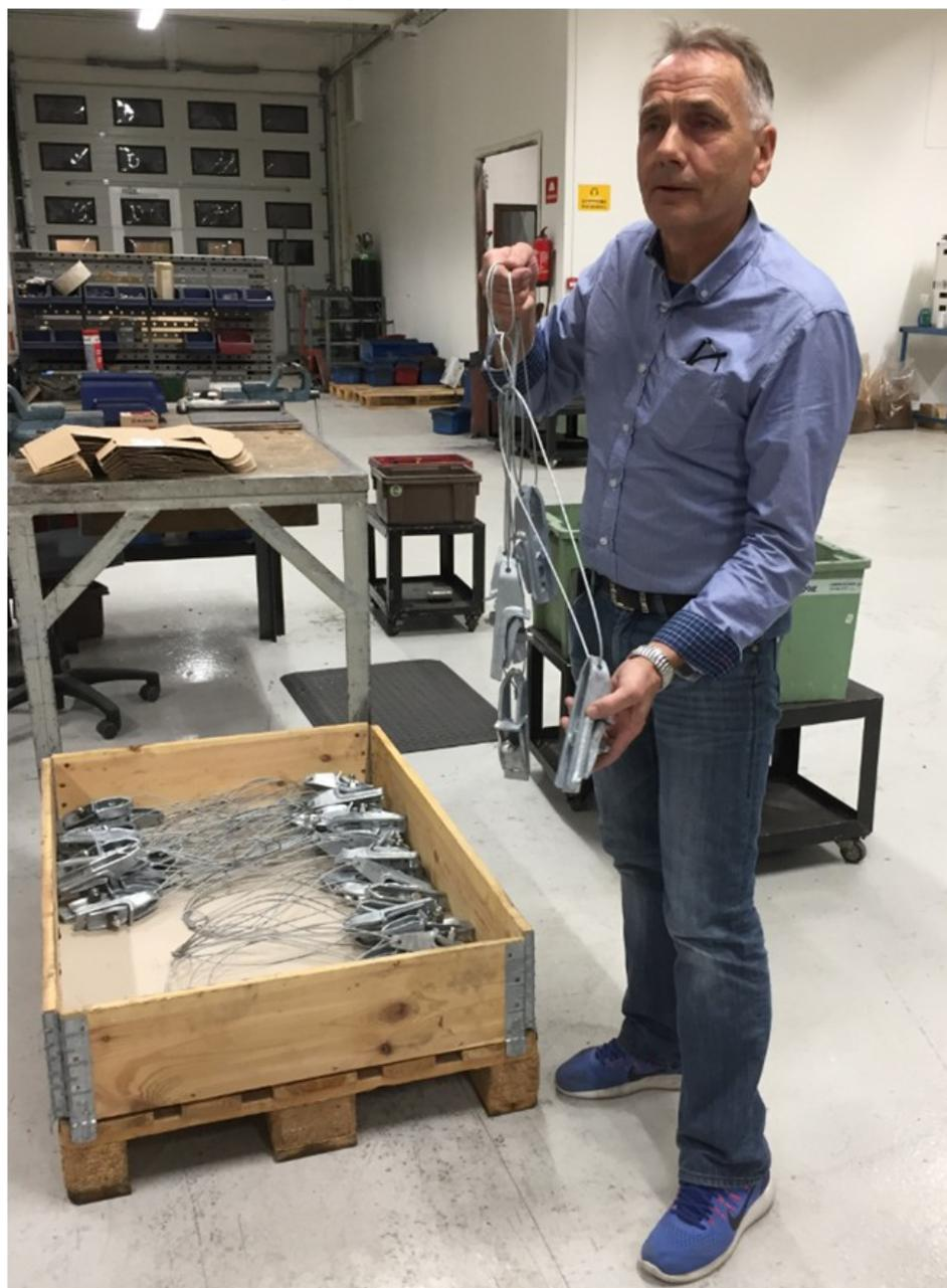
«Voldaklemma»,brukt til låsing av wire-slingsar for løfting av rørbuntar.
